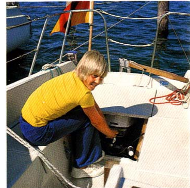
Ein Motorschacht, in dem der Außenborder zur Einbaumaschine wird.
